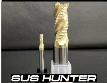
刃径公差12 $\geq$ 0~-0.02 / 12<0~-0.03 シャンク公差h6 /// SUSや耐熱合金に対してのポケットや溝加工へのアプローチとして3枚刃のラフィングをラインナップ(もちろん鉄にも使用可能です)。通常3枚刃の場合4枚刃に比べて送りスピードを上げにくいですが、ラフィング形状にすることにより加工抵抗を抑え送りスピードを上げ易くすると、切粉の排出をよりスムーズにするコンセプトのもとに開発いたしました。耐熱合金に相性の良いCGコーティングを施しておりますのでSUS316、インコネルやハステロイなどの難削材の加工に非常に良い効果を発揮できます。
