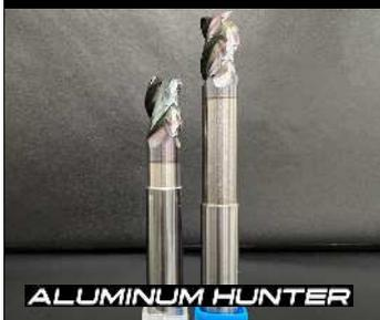
刃径公差12≧0~-0.02 / 12<0~-0.03 シャンク公差h6 /// 水素フリーDLCコーティング付3枚刃ネット付アルミ用エンドミルです。日本メーカー製良品母材を使用した品質にこだわった製品です。水素フリーDLCは通常のDLCよりコーティング膜が薄く刃のシャープ度を保持したまま、滑り性は抜群でコーティングの表面硬度は通常のDLCコーティングの約2倍を誇ります(HDC約5000Hv DLC約2000Hv)。故にアルミのドライ加工を実現できます。ハイクラスのエンドミルでありながら安価に抑えています。切削有効長3Dと5Dをシリーズ内に取り揃えております。
