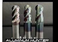
刃径公差12≧0°-0.02 / 12 <0°-0.03 シャンク公差h6 /// 水素フリーDLCコーティング付のアルミ用防振型ボール 素フリーDLCの硬度は約5000HVをマークしており、表面に滑り性をもたせアルミの高速加工に最適です。より切れ味を持 コーティングにより刃先欠損を担保しながら高い加工条件でより安定性を持たせ、長寿命に使用できるコンセプトで開発され ルです。アルミには抜群の威力を発揮いたします。シリーズ内2枚刃、3枚刃、4枚刃からお選び下さい。
