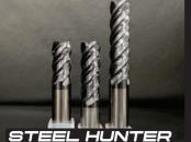
刃径公差12≥0°-0.02 / 12<0°-0.03 シャンク公差h6 /// AlTiNコーティングを施したハイヘリカル防振エンドミルです。高リッチにア ルミを配合し、耐熱性、耐磨耗性に優れております。超微粒子母材を採用し高品質安価をコンセプトにしております。一般部品加工にはこちらの 商品がコスト的にメリットが御座います。
