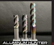
刃径公差12≥0^-0.02 / 12<0^-0.03 シャンク公差h6 /// 不等リード不等分割の防振機能をもたせ水素フリーDLCコーティングを装着したアル ミ用スクエアエンドミルです。水素フリーDLCは通常のDLCよりコーティング膜が薄く刃のシャーブ度を保持したまま、滑り性は抜群でコーティングの表 面硬度は通常のDLCコーティングの約2倍を誇ります(HDC約5000Hv DLC約2000Hv)。故にアルミのドライ加工を実現できます。ハイクラスのエ ンドミルでありながら安価に抑えております。
