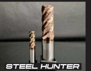
刃径公差12≥0^-0.02 / 12<0^-0.03 シャンク公差h6 /// TOTIMEの強ねじれ防振型ラフィングエンドミルです。高硬度用のPOWER コーティングは母材との密着性も高く、コーティング硬度3800Hv、耐熱性1000度、高リッチにアルミ成分を配合しているためコーティング表 面に熱がかかることにより酸化アルミの形成膜ができ非常に硬くて耐摩耗性に優れたコーティング膜を形成します。
