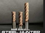
刃径公差12≥0~-0.02 / 12<0~-0.03 シャンク公差h6 /// 高硬度用のPOWERコーティングは母材との密着性も高く、 度3800Hv、耐熱性1000度、高リッチにアルミ成分を配合しているためコーティング表面に熱がかかることにより酸化アルミの 非常に硬くて耐摩耗性に優れたコーティング膜を形成します。水溶性切削液の使用とともに加工も行えますが、コーティングの良 活かす場合はドライ加工を推奨いたします。SCMやSKDといった生材においてもこちらのPOWERコーティングをご使用するこ
