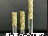
刃径公差12≥0~-0.02 / 12<0~-0.03 シャンク公差h6 /// CGコーティングは非常に高いスペックをもち、コーティングの硬度は 4200HV、最高使用温度1100°をマークし乾湿両用で使用できます。多層コーティングで表面に滑り性をもたせ、耐熱合金、ステンレス、鋼全般 に使用できます。ハイスペックコーティングにより刃先欠損を担保しながら高い加工条件でより安定性を持たせ、長寿命に使用できるコンセプト で開発されたエンドミルです。ステンレスには抜群の威力を発揮いたします。
