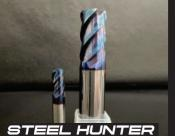
刃径公差12≥0~-0.02 / 12<0~-0.03 シャンク公差h6 /// ハイヘリカル高硬度用コーナーラジアスエンドミル。母材は高級日本製母材 0.2μmを使用、コーティング硬度は4500Hv、耐熱温度1200度で、非常にスペックが高いBlue nanoコーティングを採用しております。鍛あればこれ一本で一般鋼から高硬度材までご使用頂けますが、芯厚が厚い分、径方向への切込量を深くかけますと目詰まりを起こす可能性も座います。焼入れ後の仕上げ、もしくはトロコイド加工のような「径方向に薄く軸方向に深く」+「送りスピードを速く」に向いております。ステンスへのご使用はお勧めいたしません。(本来のコーティングの性能を活かすのであればドライ推奨です)
