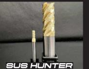
刃径公差12≥0~-0.02 / 12<0~-0.03 シャンク公差h6 /// TOTIMEの強ねじれ防振型ラフィングエンドミルです。刃形も高速切削が可能なファインニックにしております。CGコーティングは非常に高いスペックをもち、コーティングの硬度は4200HV、最高使用温度1100°をマークし乾湿両用で使用できます。多層コーティングで表面に滑り性をもたせ、耐熱合金、ステンレス、鋼全般に使用できます。ハイスペックコーティングにより刃先欠損を担保しながら高い加工条件でより安定性を持たせ、長寿命に使用できるコンセプトで開発されたエンドミルです。ステンレスには抜群の威力を発揮いたします。
