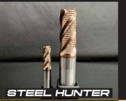
刃径公差12≥0^-0.02 / 12<0^-0.03 シャンク公差h6 /// TOTIMEの中ねじれ防振型ラフィングエンドミルです。高硬度用のPOWER コーティングは母材との密着性も高く、コーティング硬度3800Hv、耐熱性1000度、高リッチにアルミ成分を配合しているためコーティング表 面に熱がかかることにより酸化アルミの形成膜ができ非常に硬くて耐摩耗性に優れたコーティング膜を形成します。
