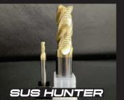
刃径公差12≥0^-0.02 / 12<0^-0.03 シャンク公差h6 /// SUSや耐熱合金に対してのポケットや溝加工へのアプローチとして3枚刃のラフィングをラインナップ(もちろん鉄にも使用可能です)。通常3枚刃の場合4枚刃に比べて送りスピードを上げにくいですが、ラフィング形状にすることにより加工抵抗を抑え送りスピードを上げたくいですが、ラフィング形状にすることにより加工抵抗を抑え送りスピードを上げたしました。耐熱合金に相性の良いCGコーティングを施しておりますのでSUS316、インコネルやハステロイなどの難削材の加工に非常に良い効果を発揮できます。
